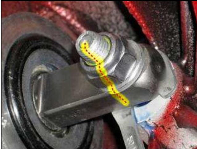
● 使用可擦除的黄色标记笔或油漆，在紧固下臂的双头螺栓和相关螺母以及衬套 (flanbloc) 有眼螺栓上做参考标记。
