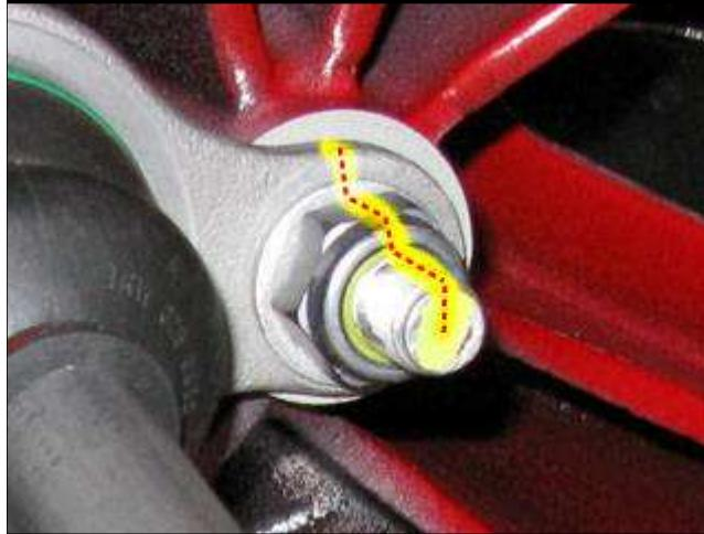
用可擦除的黄色标记笔或油漆，在紧固前束拉杆的螺纹杆和相应螺母以及有眼螺栓上做参考标记。
