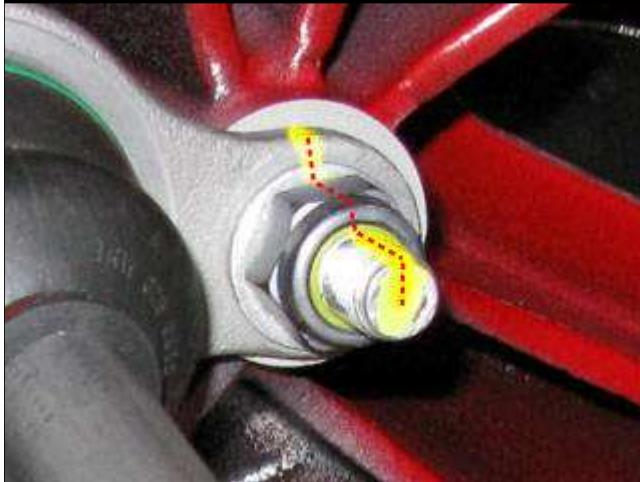
● 检查并确认正确对齐黄色参考标记：螺纹杆上的标记和有眼螺栓上的标记必须对齐。
